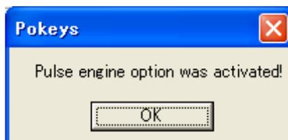
3. 8. 上の方の Enable PoKeys pulse engine にチェックをつけて、OK ボタンをクリックしてください。その後、Mach3 を終了してください。
