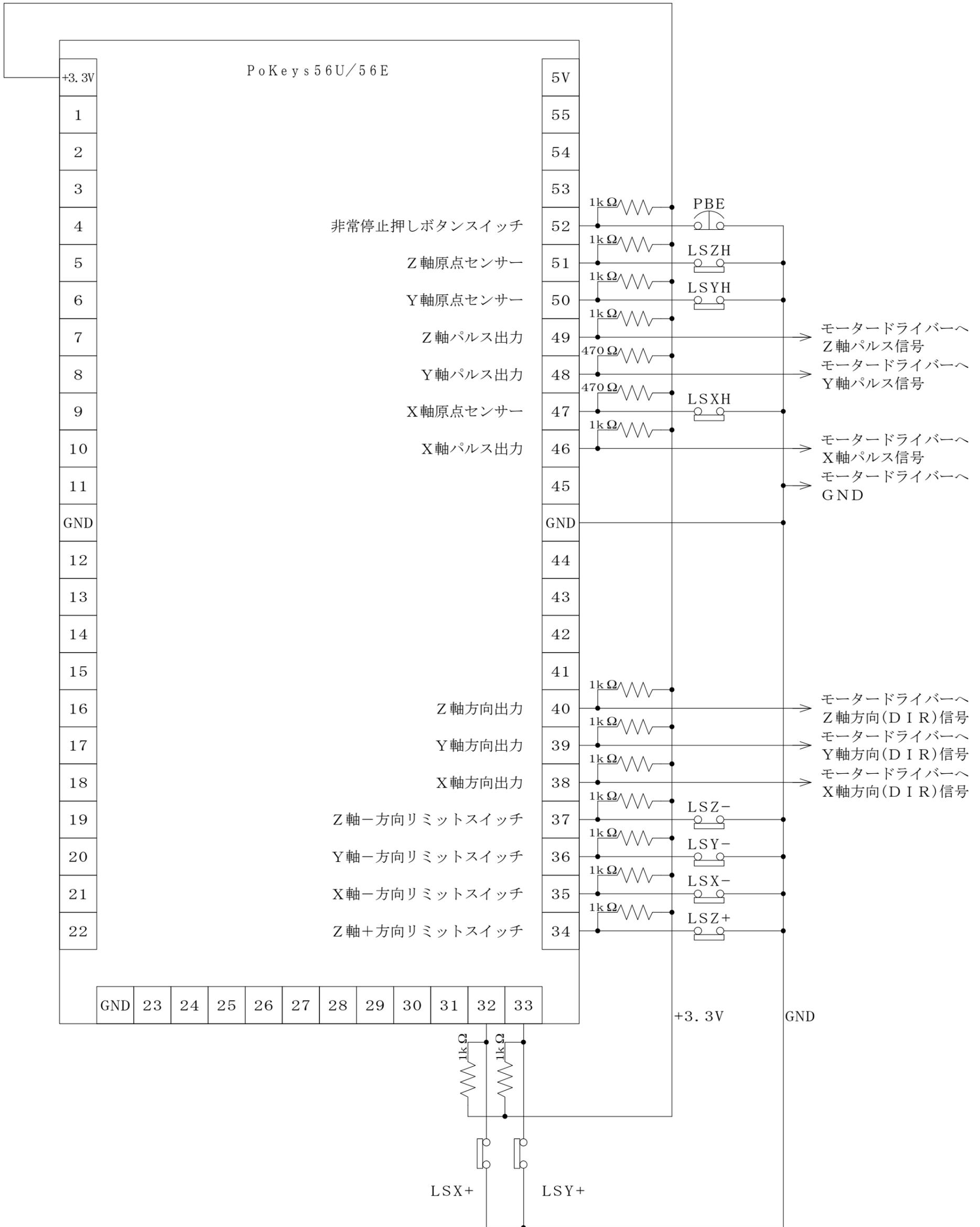
非常停止ボタン、原点センサー(スイッチ)、リミットスイッチは b 接点 (NC、ノーマルクローズ、押したときにOFFになる接点) をご使用ください。
